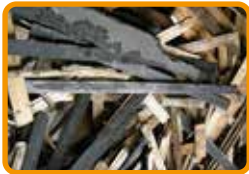
Altholz mit Bitumen- anstrich, Dachpappe
